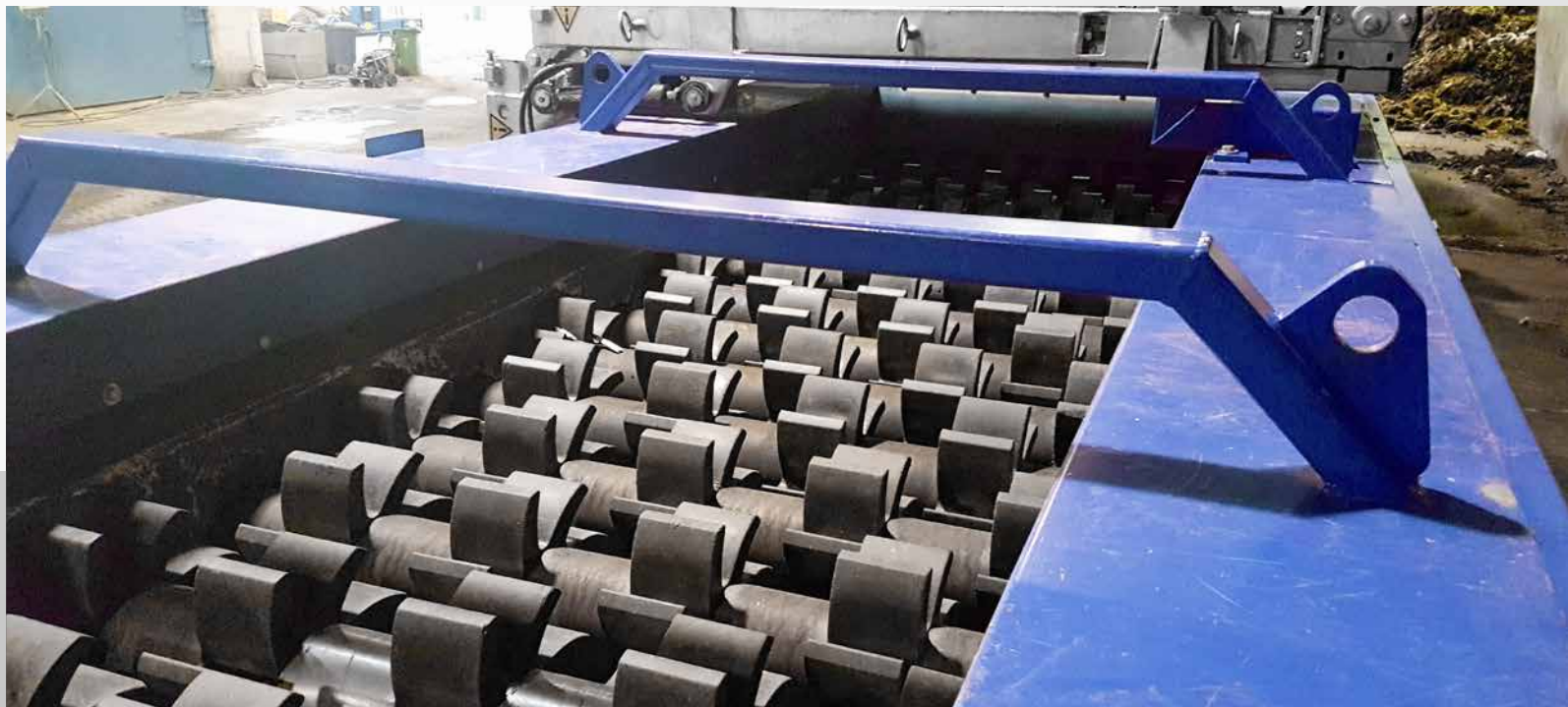
Sijojimo denių kasetinė konstrukcija
